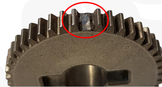
Vylomený zub převodovky
