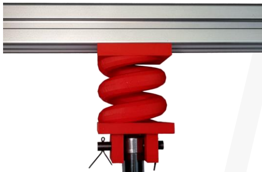
Tlumič - pružina vytištěna z PLA
