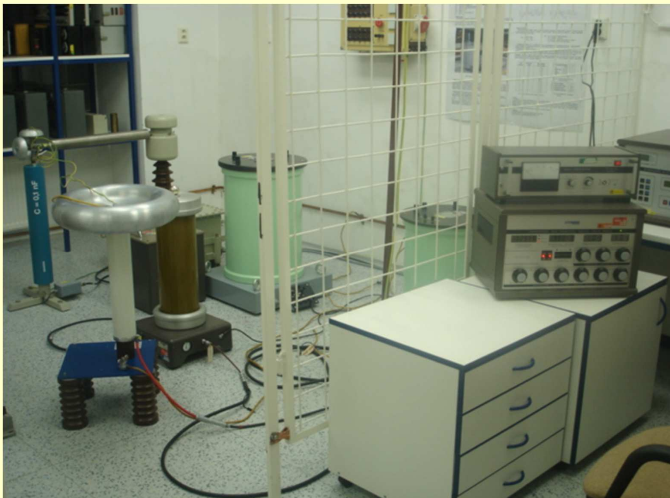
KALIBRACE VN KONDENZÁTORU POMOCÍ TRANSFORMÁTOROVÉHO MOSTU
