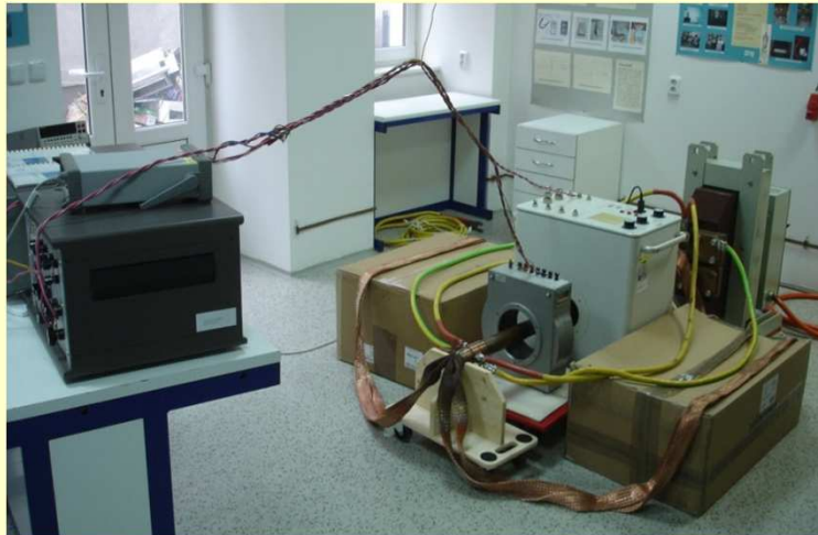
Kalibrace MTP 8 kA/5A systémem Tettex
